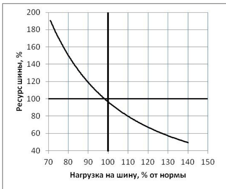
Зависимость ресурса шин от нагрузки
