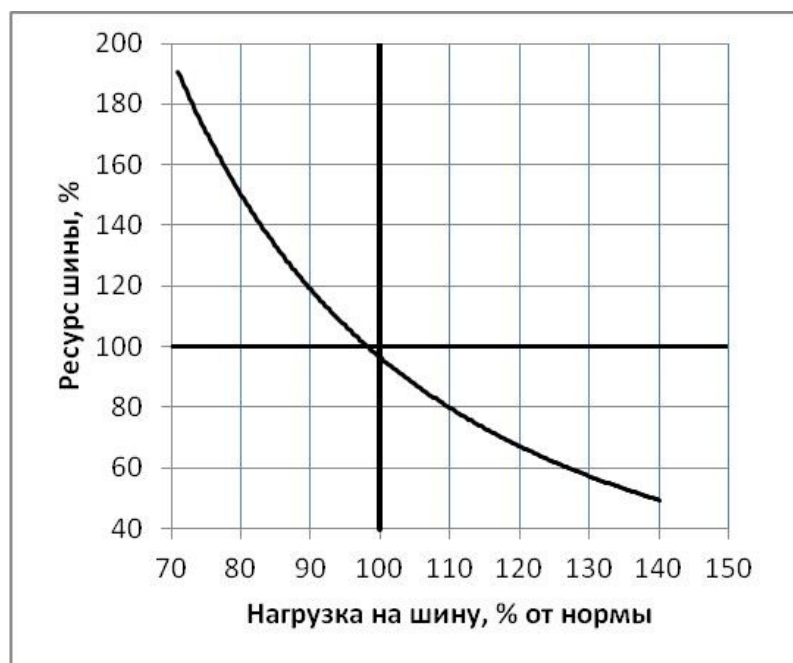
Зависимость ресурса шин от нагрузки
