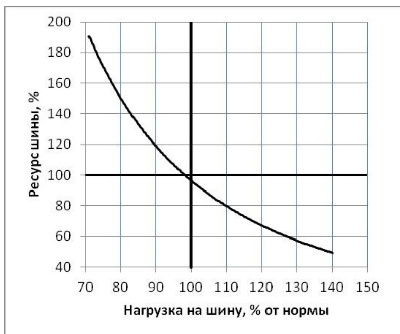
Зависимость ресурса шин от нагрузки
