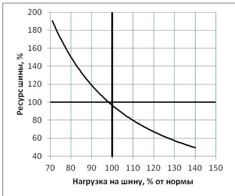
Зависимость ресурса шин от нагрузки
