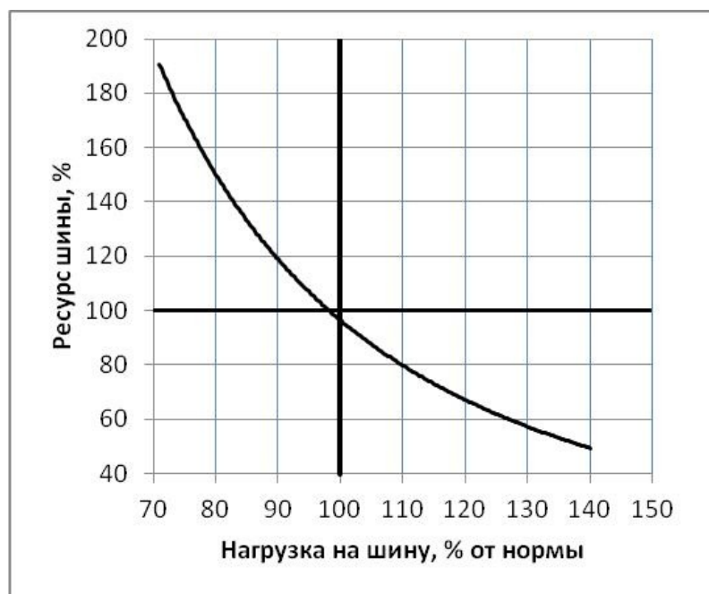
Зависимость ресурса шин от нагрузки
