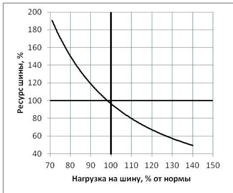
Зависимость ресурса шин от нагрузки
