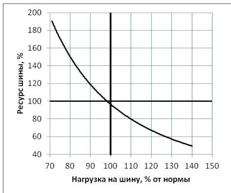
Зависимость ресурса шин от нагрузки
