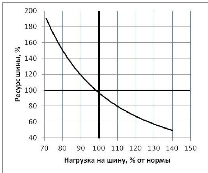
Зависимость ресурса шин от нагрузки
