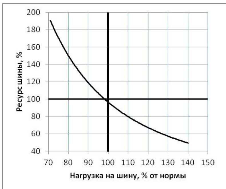
Зависимость ресурса шин от нагрузки
