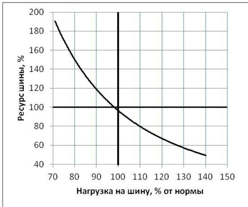
Зависимость ресурса шин от нагрузки
