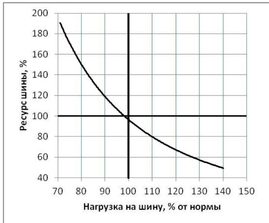
Зависимость ресурса шин от нагрузки
