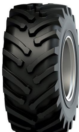
Сельскохозяйственные шины типоразмеров радиальной конструкции с протектором R-1W предназначены для эксплуатации на ведущих колесах тракторов отечественного и зарубежного производства, выполняющих работы в сельском хозяйстве. Шины используются так же и для сдвоенных колес.
