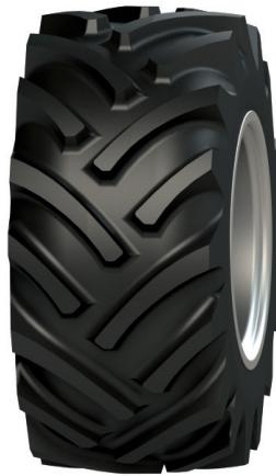
Шина предназначена для эксплуатации на ведущих колесах тракторов. Эксклюзивный «длинно-короткий» дизайн грунтозацепов исключает поперечное раскачивание, даёт более равномерное распределение давления в пятне контакта, уменьшает паразитные вибрации, что даёт лучшую производительность и долгий срок службы таких шин.
